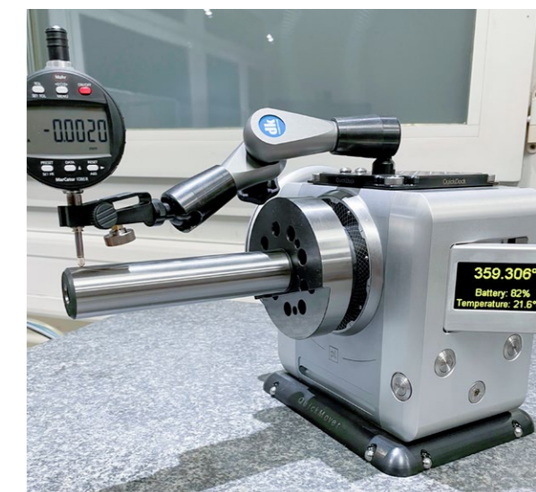
振れ精度測定例 ダイヤルゲージをグリッドプレートに設置 DKグリッドプレート：オプション設定 測定工具マウント用
