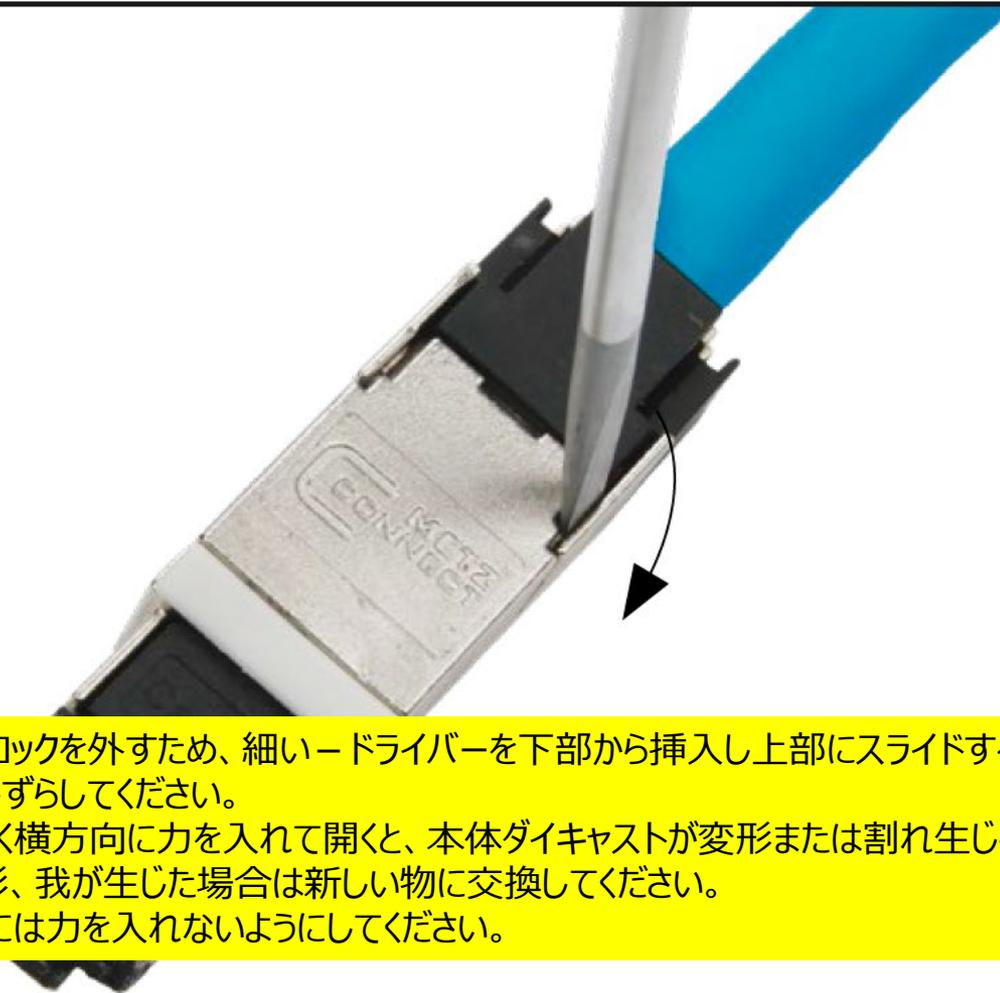
(注意) 片側のノッチのロックを外すため、細いードライバーを下部から挿入し上部にスライドする方向に力を入れて少しずつずらしてください。
